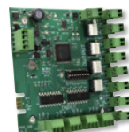
AC-IOE Carte d'extension E/S à huit ports (inclus avec les trousse de démarrage ACS-ELV et ACS-IO)
