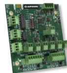
AC-2DE Carte d'extension à deux portes (inclus avec les trousse de démarrage ACS-2DR-C et ACS-ELV)
