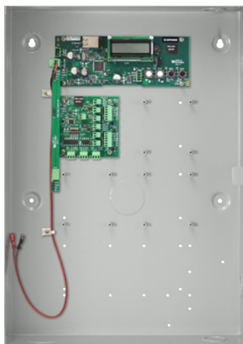
ACS-2DR-C Trousse de démarrage de contrôle d'accès à deux portes avec boîtier (comprend une trousse de démarrage ACS-2DR et un boîtier AC-C, qui comporte un espace pour le bloc d'alimentation AC-PS1250 requis jusqu'à trois cartes d'extension AC-2DE peut être ajouté pour une capacité de huit portes)
