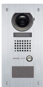
AX-DVF-P Unidad de puerta con video con lector de tarjetas de proximidad HID® (requiere un anfitrión de terceros y un cable adicional para alimentar el lector de tarjetas)
