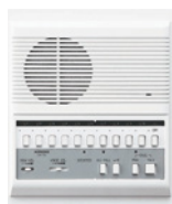
LEF-10C Unidad maestra con audio, con capacidad para llamar a 10 unidades con apertura de puerta y llamada a todas las unidades (requiere BG-10C)
