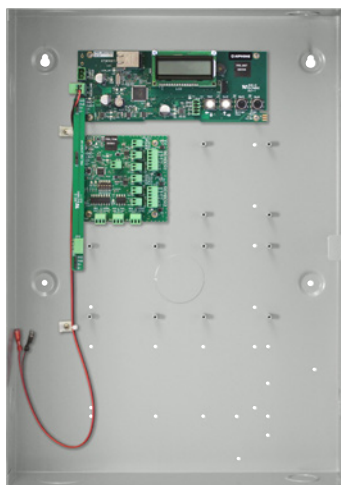
ACS-2DR-C Kit básico de control de acceso para dos puertas con carcasa (incluye un kit básico ACS-2DR y una carcasa AC-C, que tiene espacio para una fuente de alimentación AC-PS1250—hasta tres placas de expansión AC-2DE se pueden agregar para una capacidad de ocho puertas.)
